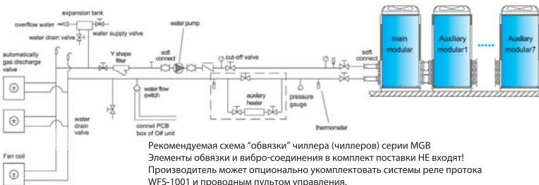
Цикл работы модульной сборки чиллеров
