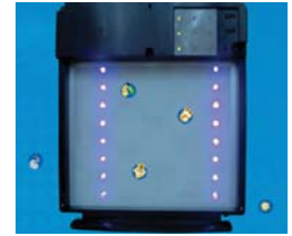
Внутри блока находятся 16 светодиодных УФ-ламп, широкий спектр излучения которых уничтожает микроорганизмы, в том числе вредные бактерии и плесень.
